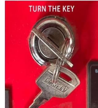
**(4) Avvio motore 452cc:** Spostare la leva dell'acceleratore sul lato sinistro del motore al massimo. Ruotare la chiave per avviare il motore. Per spegnere il motore, ruotare la chiave in posizione OFF.
